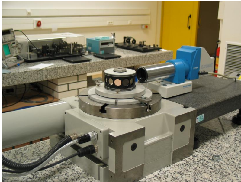
Σχήμα 1. Σύστημα διακρίβωσης προτύπων γωνιών.
